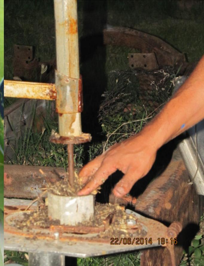
**WHEN MIX IS RIGHT, SQUEEZE INTO MOLD
