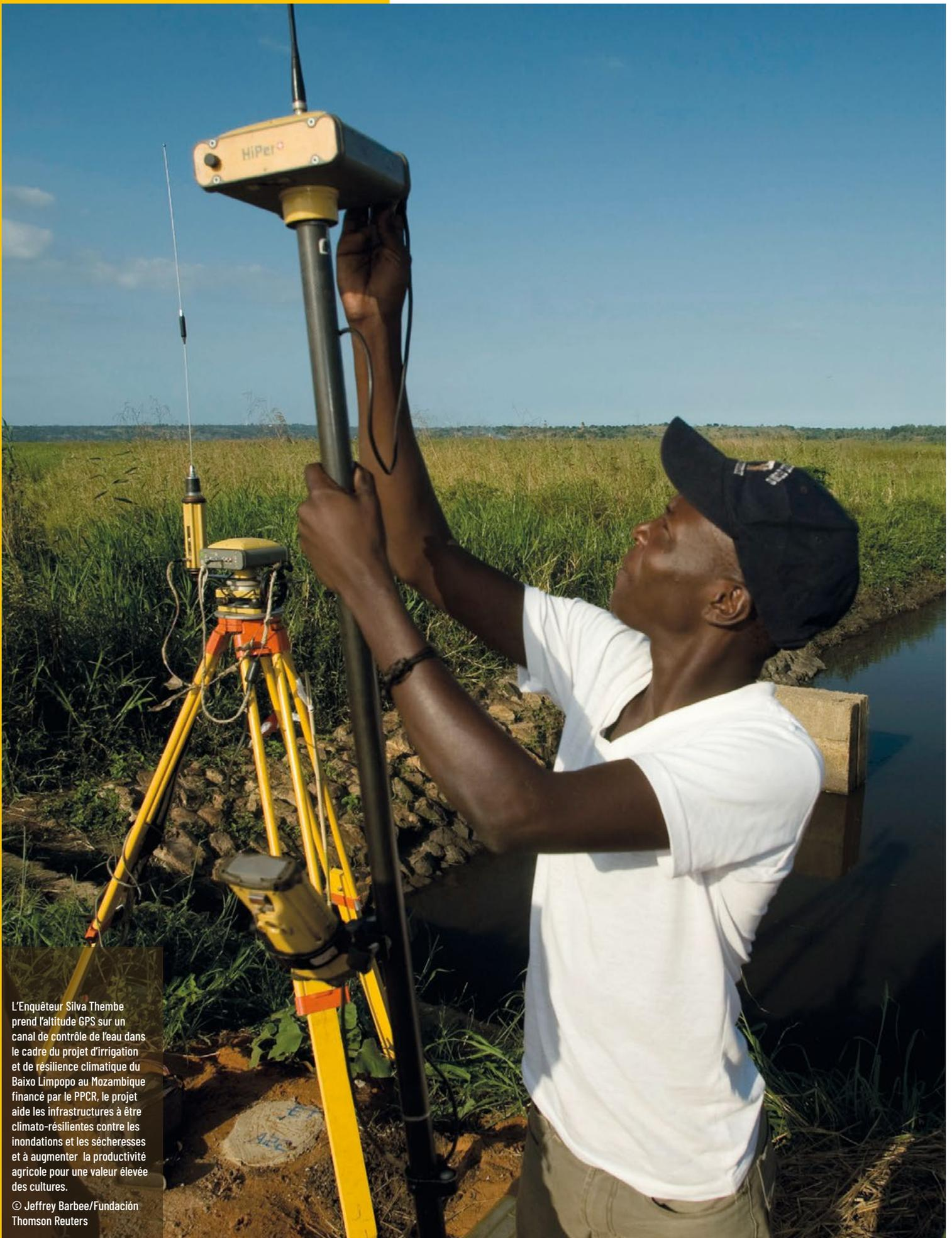
L'Enquêteur Silva Thembe prend l'altitude GPS sur un canal de contrôle de l'eau dans le cadre du projet d'irrigation et de résilience climatique du Baixo Limpopo au Mozambique financé par le PPCR, le projet aide les infrastructures à être climato-résilientes contre les inondations et les sécheresses et à augmenter la productivité agricole pour une valeur élevée des cultures.
