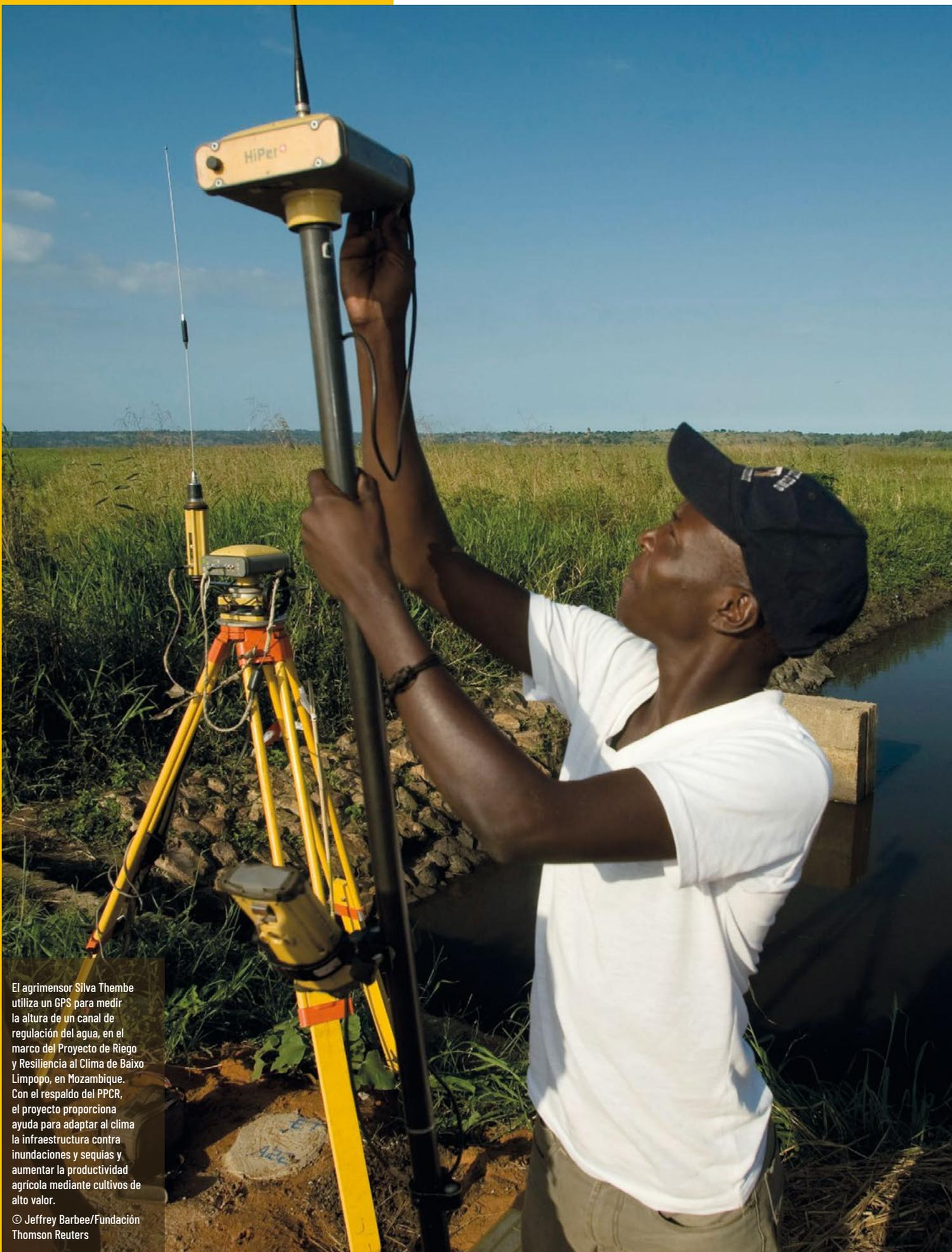
El agrimensor Silva Thembe utiliza un GPS para medir la altura de un canal de regulación del agua, en el marco del Proyecto de Riego y Resiliencia al Clima de Baixo Limpopo, en Mozambique. Con el respaldo del PPCR, el proyecto proporciona ayuda para adaptar al clima la infraestructura contra inundaciones y sequías y aumentar la productividad agrícola mediante cultivos de alto valor.
